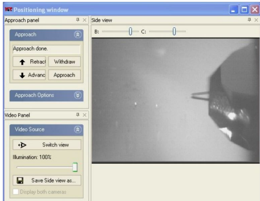
Abbildung 8: Fenster zur Grobannäherung. Links: Approach und Video Panel; rechts: Seitenansicht von Probe und Cantilever.
