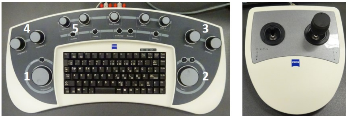
Abbildung 7: Links: Steuerkonsole für das REM. 1) Einstellung der Vergrößerung bzw. Auswahl, ob gesamter Abbildungsbereich oder nur ein Ausschnitt davon dargestellt werden soll. 2) Einstellung des Fokus. 3) Einstellung von Helligkeit und Kontrast. 4) Astigmatismus-Korrektur 5) Justage der Aperturblende. Rechts: Steuerkonsole für den Probenstisch. Mit dem linken Joystick wird die Höhe und Kippung des Tisches justiert, mit dem rechten Joystick die x- und y-Position sowie die Drehung des Proben-tellers.
