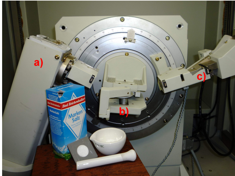
Abbildung 4: Versuchsaufbau für die Beugung an Kristallpulvern: (a) Röntgenröhre, (b) Probenhalter, (c) Detektor. Im Vordergrund ist ein NaCl Präparat zu sehen
