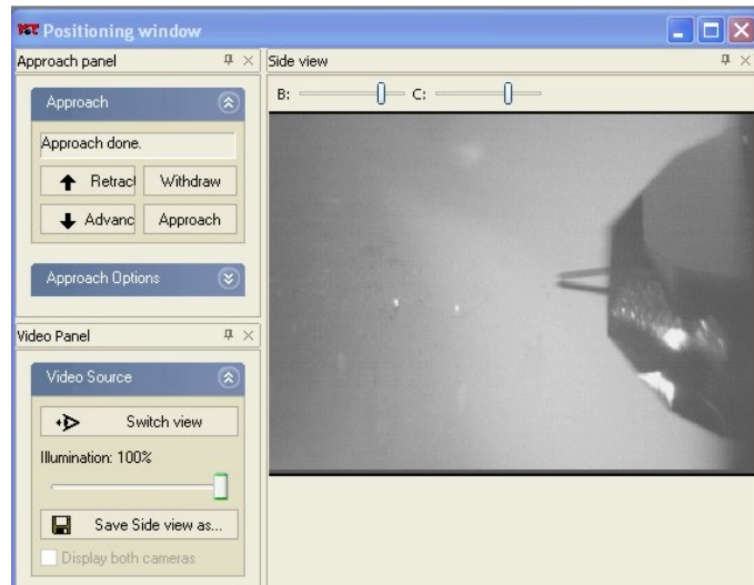
Abbildung 8: Fenster zur Grobannäherung. Links: Approach and Video Panel; rechts: Seitenansicht von Probe und Cantilever.
